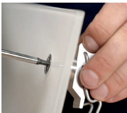
Vložte kroužek a šroub do zapuštěného otvoru v panelu a utáhněte jej pomocí šroubu.
