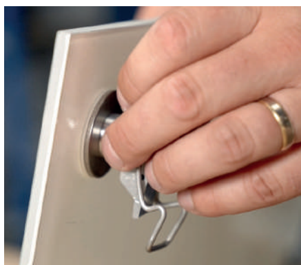
Vložte kroužek a šroub do zapuštěného otvoru v panelu a utáhněte jej pomocí šroubu.
